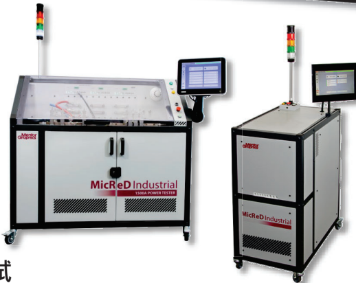
DynTIM 材料熱傳導係數量測
