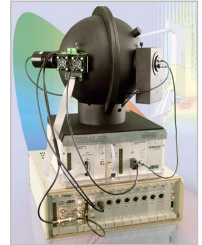
TeraLED LED光熱耦合量測積分球
