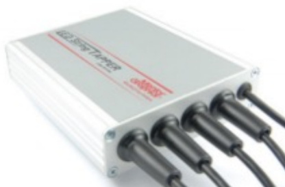
LED串聯器 可串聯4顆LED量測 使用2台可串聯8顆
