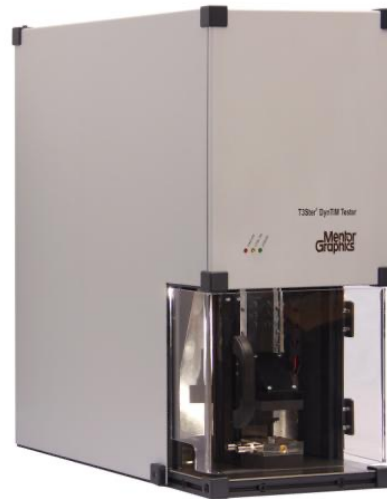
DynTIM 材料導熱係數 量測設備
